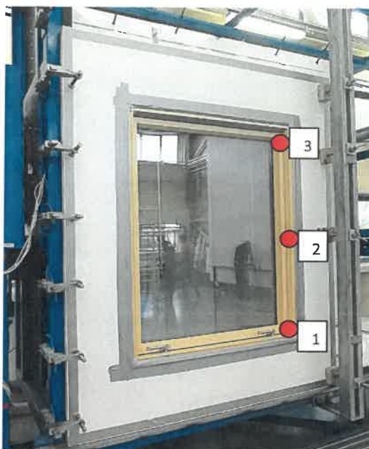
Fot. 4. Rozmieszczenie punktów pomiarowych
