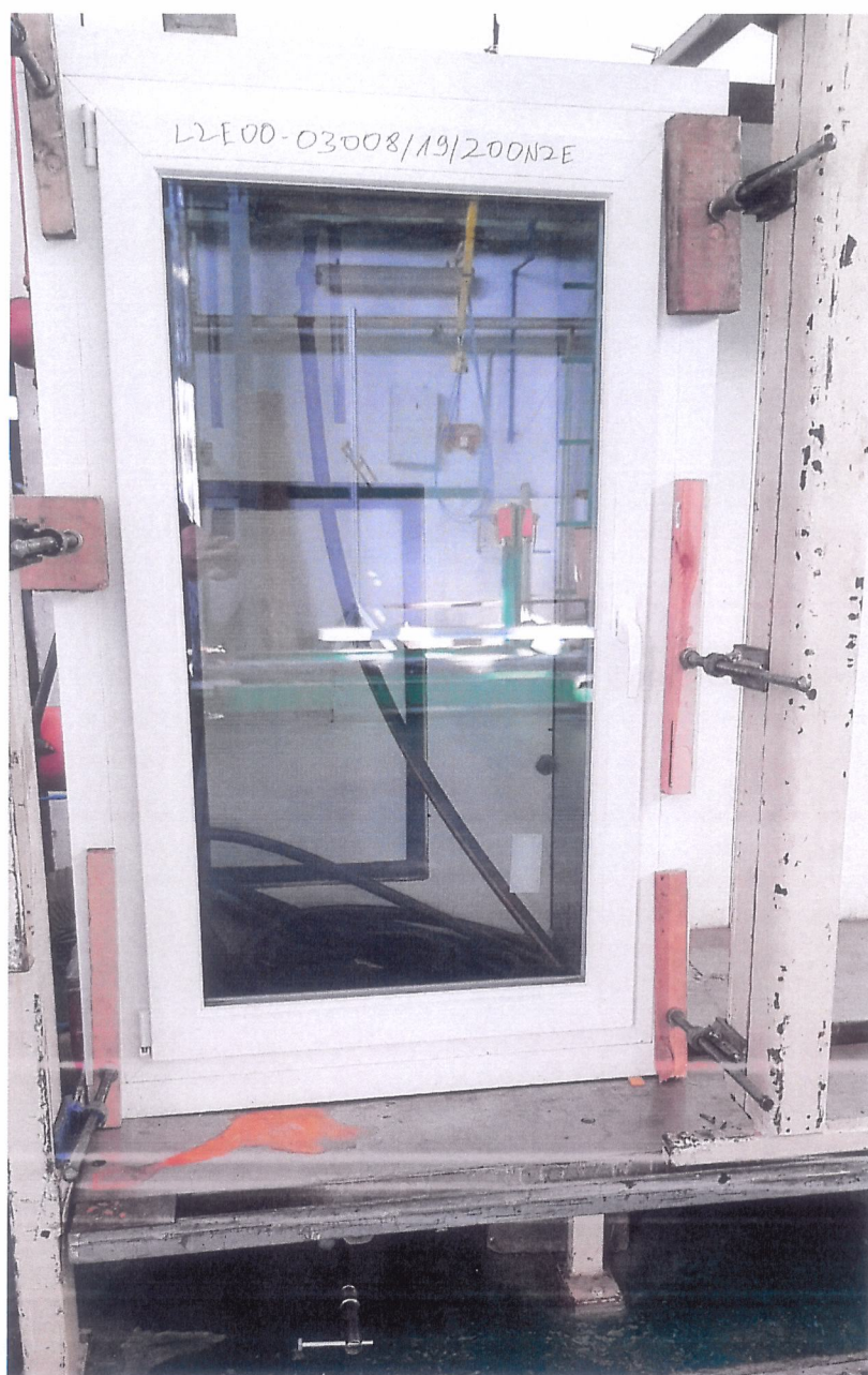
Fot. 3. Widok próbki - okna osadzonego w komorze badawczej (zdjęcie wykonane przez Laboratorium LZE)
