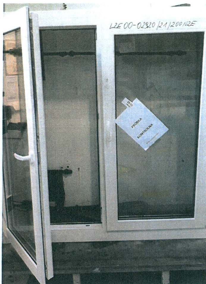
Fot. 5. Widok okna (próbki badawczej) osadzonego w komorze badawczej (zdjęcie wykonane przez Laboratorium LZE)
