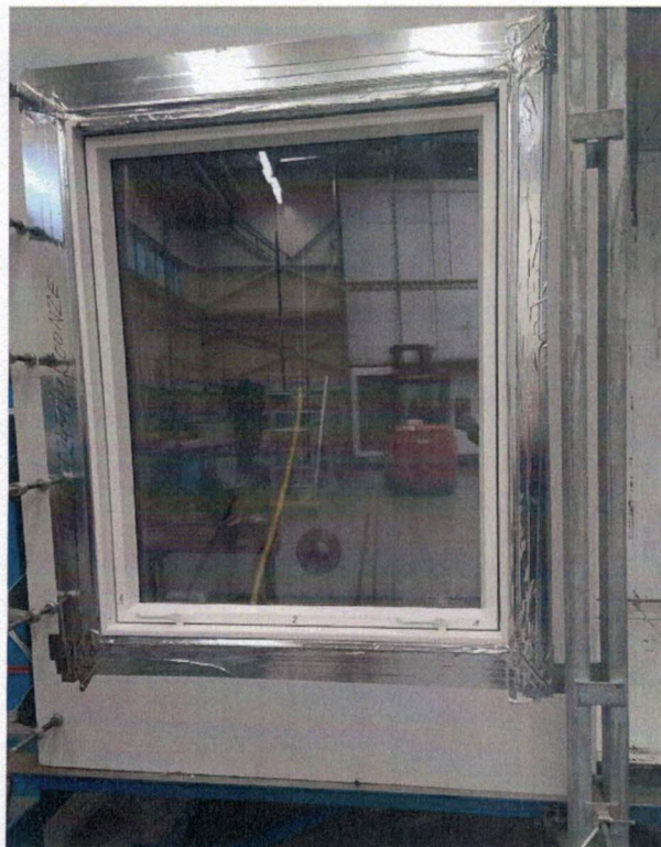
Fot. 2. Widok okna (próbki badawczej) osadzonego w komorze badawczej (zdjęcie wykonane przez Laboratorium LZE)
