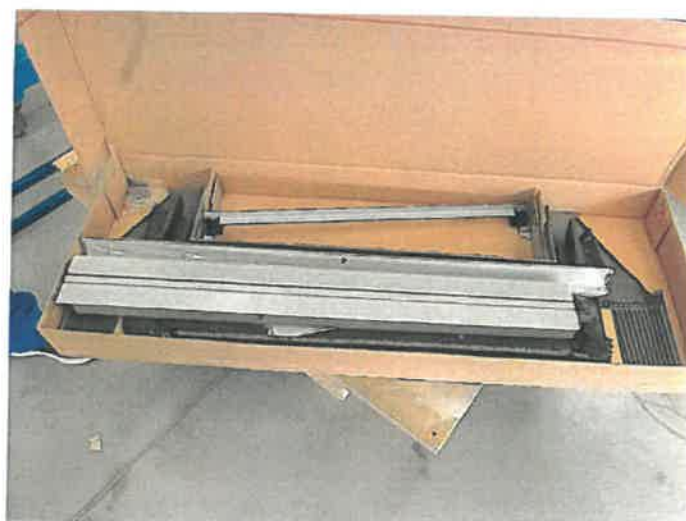
Fot. 2. Widok okna (a) wraz z kołnierzem uszczelniającym (b) przed badaniem (zdjęcia wykonane przez Laboratorium LZE)
